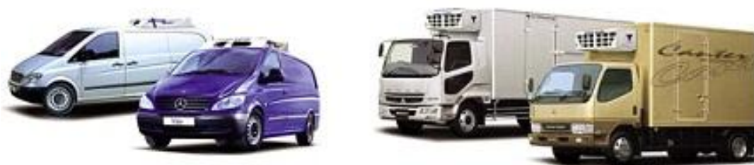
Рис.1. Модели автомобильных холодильных установок с приводом от двигателя автомобиля [1]
