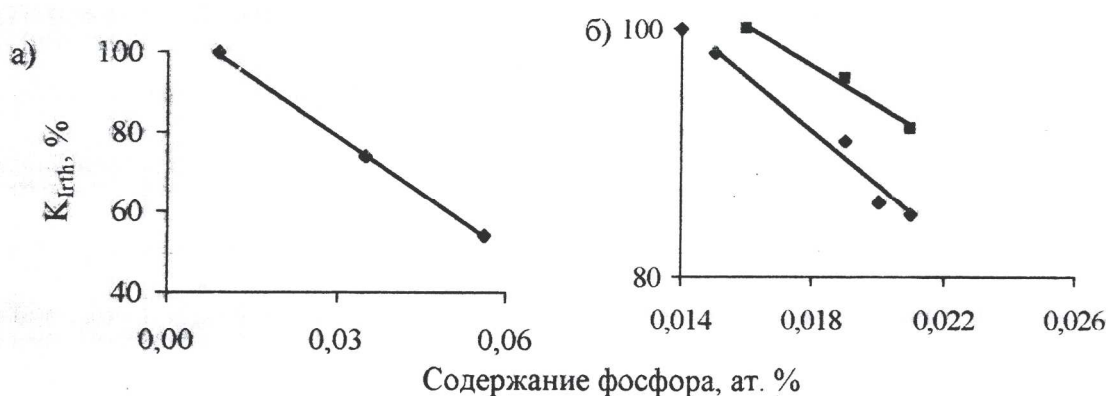
Рис. 2. Влияние содержания фосфора на снижение пороговых значений вязкости разрушения:
