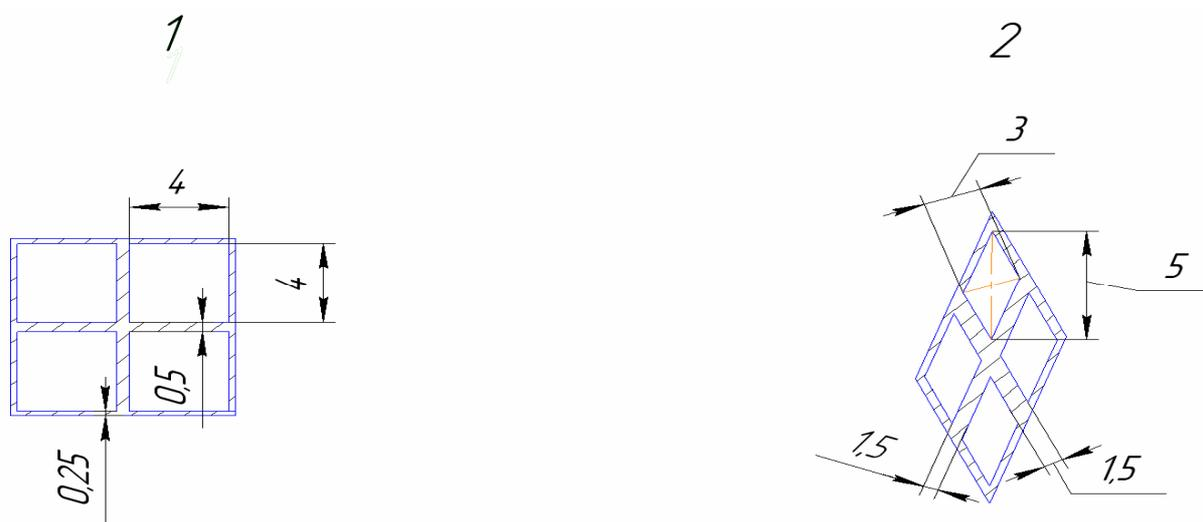
Рис.2. Поперечное сечение каналов насадки.
