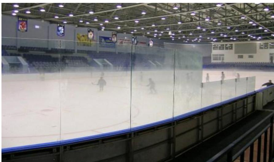
**Рис.11** Образование конденсата на защитных стеклах хоккейных бортов
